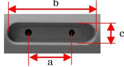
電気手術器本体のバイポーラ出力端子の外形寸法
